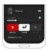
4 点击更多设置 > 声音模式,选择低增益模式,最大声压级可达到 130 dB,轻松避免爆音与失真,显著提升录音质量。
